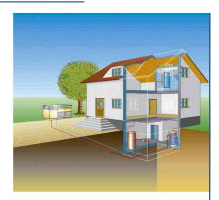
Kreislauf wieder von vorne beginnen, denn das Kältemittel ist wieder in seinem ursprünglichen Zustand im Verdampfer angelangt. Natürlich wird für diese Technik nicht ausschließlich Luft benötigt, auch Primärenergie (Strom) ist nötig, um die Wärmepumpe zu betreiben. Der Stromverbrauch ist in der Regel jedoch gering. Lediglich bei sehr kalten Außentemperaturen muss die angesaugte Luft zusätzlich Nachgeheizt werden, was zu einem höheren Primärenergiebedarf führt.
