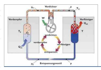
entsprechend modifiziert werden. Im Prinzip wird hierbei lediglich die Funktion der Wärmepumpe umgekehrt. Anstatt die Wärme des Mediums (Luft, Wasser, Erde) an das Kältemittel abzugeben und durch Verdichtung auf ein für Heizzwecke geeignetes Temperaturniveau zu bringen, wird die Fließrichtung einfach umgekehrt. So wird das Kältemittel vom Verflüssiger nicht mehr verflüssigt.
