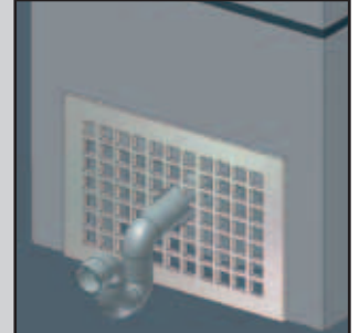
6.4 Hinweis: Kondensatablauf und Syphon ist bauseits herzustellen
