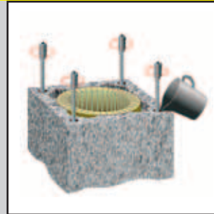
13.1 Schiedel Bewehrungsset für größere Höhen über Dach
