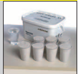
8.4 Fugenkitt anmischen Verhältnis: 7 Teile Fugenkitt auf 1 Teil Wasser
