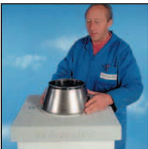
5.5 Konus als Messhilfe aufsetzen
