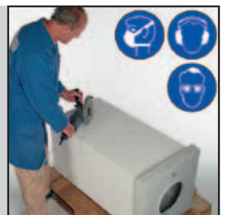
Mit Winkelschleifer zuschneiden
