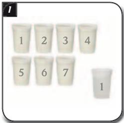
**Mischungsverhältnis** für **Muffenkitt** beachten: 7:1 **Dünnbettmörtel** mit Wasser anrühren bis gewünschte Konsistenz erreicht ist.
