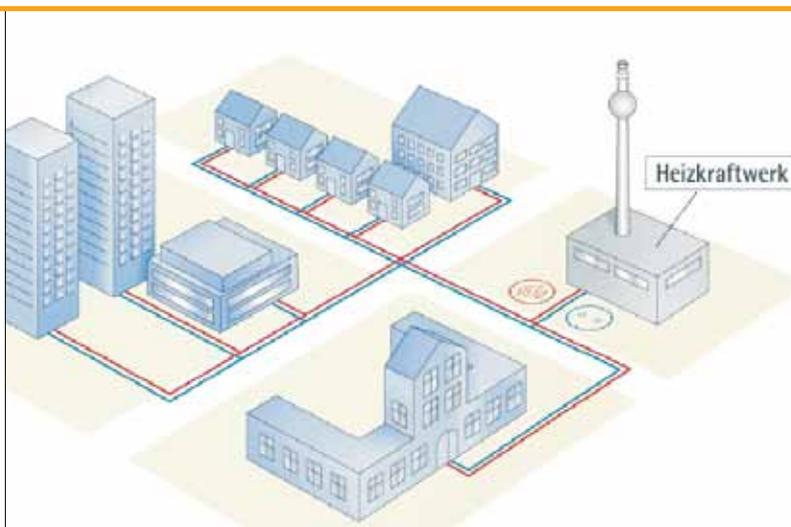
Das Speicher-Lade-System kombiniert die beiden Varianten miteinander und wird auf einen Durchschnittswasserverbrauch ausgelegt, der ebenfalls eine kleinere Auslegung des Fernwärmeanschlusses erlaubt. Bei allen Varianten wird das abgekühlte Wasser nach dem Gebrauch über die Hausstation wieder an das Rohrsystem des Versorgers abgegeben und zur Erzeugeranlage zurück transportiert.
