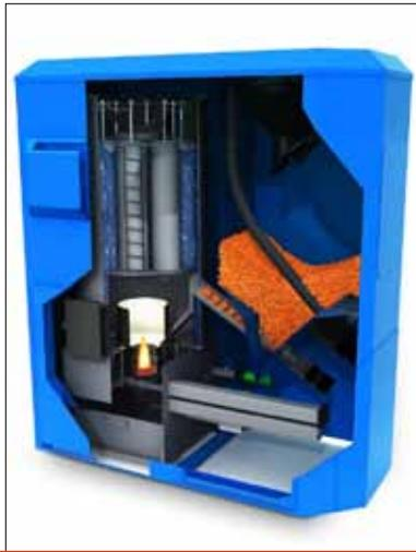
im Heizungskreislauf zu erwärmen. Zunächst muss aber ein Verbrennungsvorgang eingeleitet werden, um überhaupt Wärme zu erzeugen. Hierzu können die Holzpellets sowohl automatisch per Förderschnecke, pneumatisch über Schläuche oder bei Einzelöfen per handbefülltem Vorratsbehälter in die Brennkammer des Ofens gelangen. Eine Rückbrandsicherung schützt dabei vor einem Kontakt des Feuers mit dem bevorrateten Brennmaterial.
