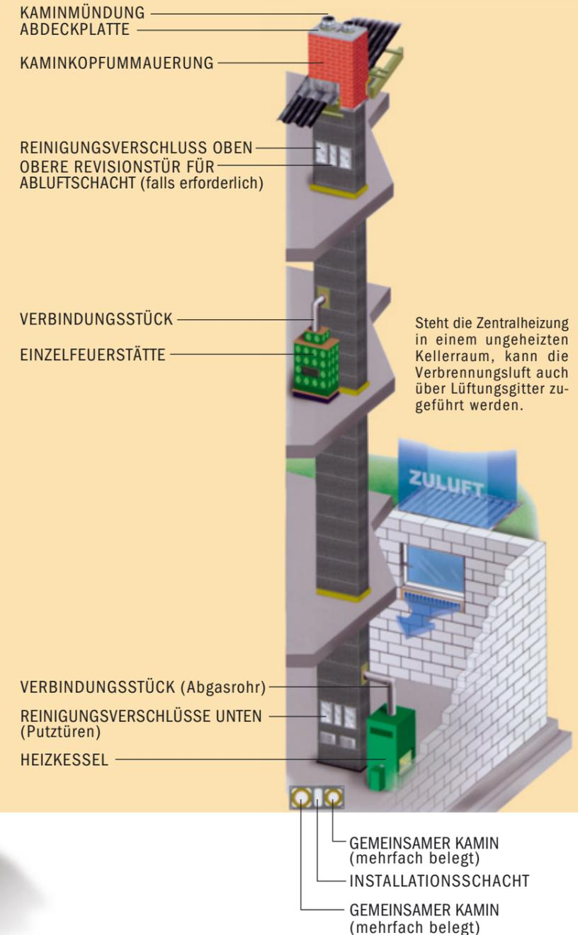
Steht die Zentralheizung in einem ungeheizten Kellerraum, kann die Verbrennungsluft auch über Lüftungsgitter zu-geführt werden.
